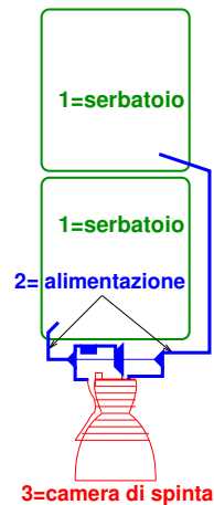
Figura 18.1: Schema dei principali sottosistemi che caratterizzano un endoreattore a propellente liquido.
