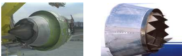
Figura 12.1: Ugelli sperimentali per la riduzione del rumore (“chevron nozzles”, da http://www.aerospace.nasa.gov/library/ar2001/arhtml/32.htm ).
