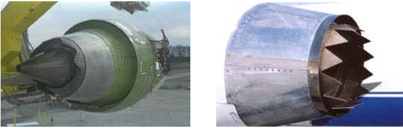
Figura 12.1: Ugelli sperimentali per la riduzione del rumore (“chevron nozzles”, da http://www.aerospace.nasa.gov/library/ar2001/arhtml ).
