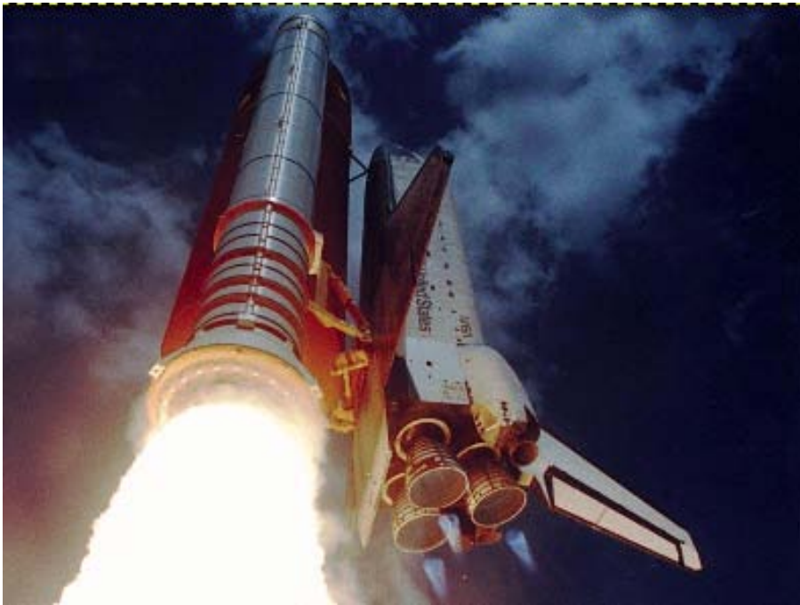
Figura 1.15: Lo Space Shuttle, con endoreattori chimici sia a propellente solido (sinistra) sia a propellente liquido (sotto la navetta).
