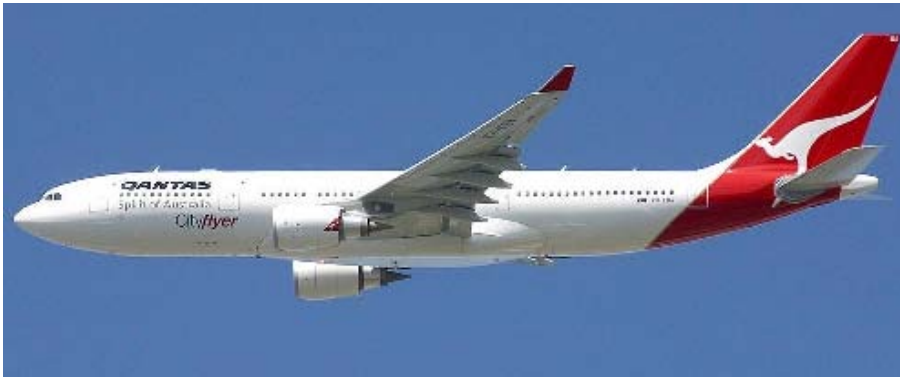
Figura 1.11: Turbofan a flussi separati CF6-80E1 della General Electric (BPR=5.2) installato su un Airbus A330.
