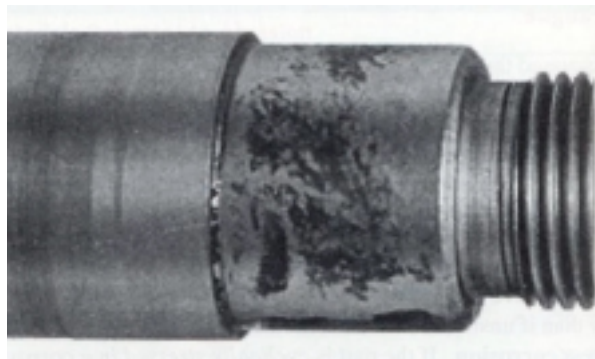
Effetti del "fretting" su un albero di trasmissione
