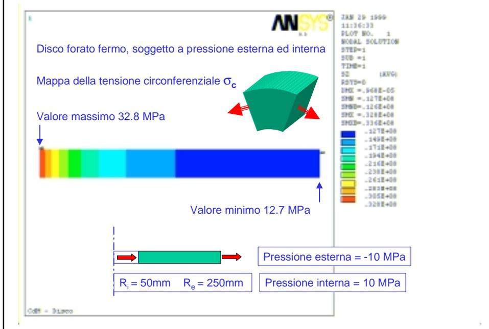
Le funzioni  $\sigma_r = B_1 + \frac{B_2}{r^2}$  e  $\sigma_c = B_1 - \frac{B_2}{r^2}$  che descrivono l'andamento delle tensioni con il raggio sono state ricavate con l'ipotesi di **stato piano di tensione**, ovvero:  $\sigma_a = 0$
