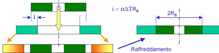
Dilatazione per riscaldamento del disco esterno
