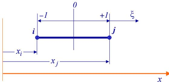
La relazione tra l'ascissa nel sistema di riferimento generale e l'ascissa espressa in un sistema di coordinate naturali dell'elemento:
