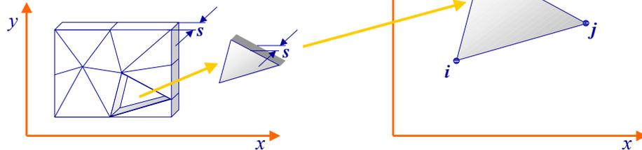
In queste condizioni è possibile rappresentare il comportamento strutturale del solido con un modello piano. Si divida il solido in una serie di elementi triangolari, di dimensioni finite. Si immagini ora di estrarre uno di tali triangoli dal continuo e di studiare il suo comportamento riferendolo ad un sistema di coordinate cartesiane.
