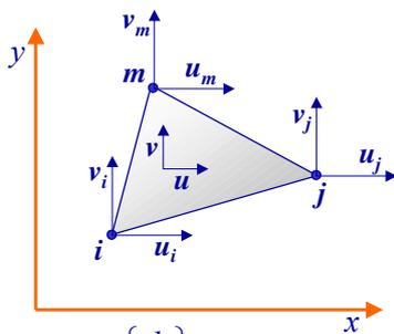
Se indichiamo con r il numero di gradi di libertà di un punto generico della struttura e con  $n_e$  il numero di nodi del singolo elemento "e" il vettore  $\{f\}$  è costituito da r termini ed il vettore  $\{d\}^e$  è costituito da  $r \times n_e$  termini.
