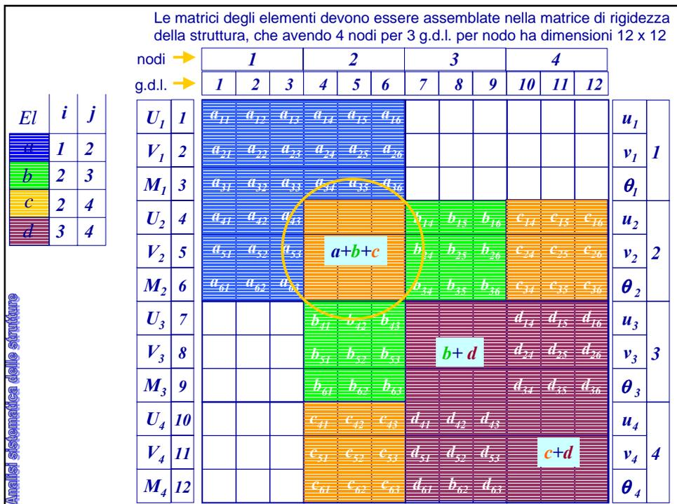
Le matrici degli elementi devono essere assemblate nella matrice di rigidezza della struttura, che avendo 4 nodi per 3 g.d.l. per nodo ha dimensioni 12 x 12
