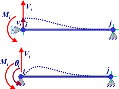
I coefficienti calcolati per il nodo  $i$ , relativi ai gradi di libertà  $v_i$  e  $\theta_i$ , possono essere espressi in forma matriciale:
