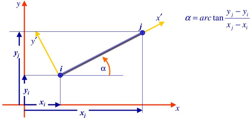
La matrice di rotazione  $[L]$  scritta nel piano, per due gradi di libertà di traslazione ed uno di rotazione, ha la forma:
