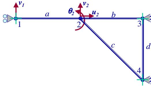
Gradi di libertà **non** vincolati:  $v_1 \quad u_2 \quad v_2 \quad \theta_2$
